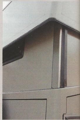
Durch das Hochfahren des Klappdaches entsteht konstruktionsbedingt ein kleiner Spalt, der von innen mit einer schmalen Klappe winddicht verschlossen wird. Alternativ bleibt der Spalt offen und dient so als Lüftung für die Kabine.
